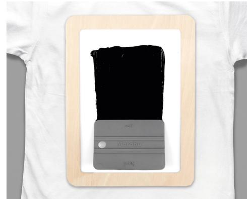
Die Farbe mit der Rakel (ohne Druck) von oben nach unten über das Motiv ziehen. So wird das Sieb geflutet. Achtung: sicher stellen, dass auf allen zu druckenden Stellen Farbe ist. Anschließend die Rakel mit gleichmäßigem Druck von oben nach unten über das Motiv ziehen. Dadurch wird die Farbe auf das Textil übertragen.
