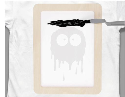
Das Sieb auf dem zu bedruckenden Textil positionieren. Die flache Seite des Siebes liegt auf dem Textil auf, damit liegt die Papierschablone direkt auf dem Stoff. Die Siebdruckfarbe gut aufrühren und dann in einer Linie, die ca. 1 cm breit ist, auf den oberen Siebrand auftragen.
